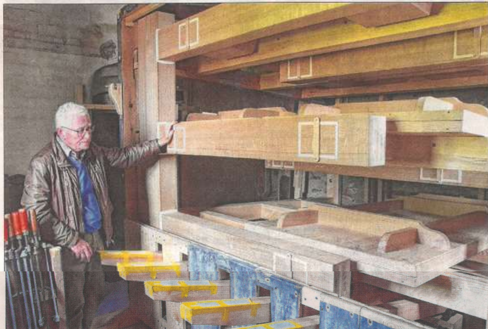
■ Jan Oostindiën bij het balghuis in de torenruimte, met de deels gereconstrueerde en vernieuwde stelling met nieuwe spaanbalgen en toebehoren. De horizontale windkanalen brengen de orgelwind van de mondingen (achter de luikjes) van de vijf balgen naar een staand kanaal. Dit kanaal is aangesloten op de twee historische kanalen die onder de vloer naar het orgel gaan.
